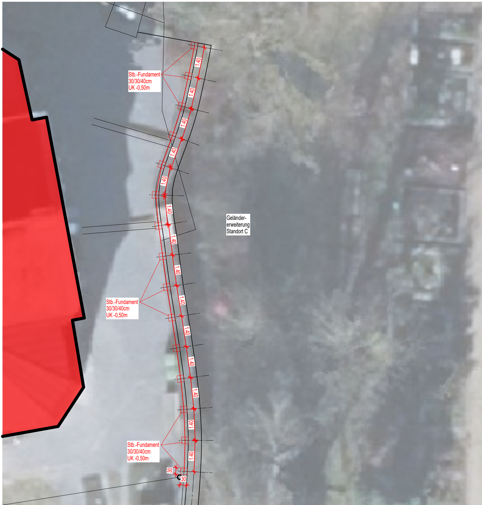
Abwicklung der Stützwand Maße teilweise gerundet oder gemittelt Vor Ausführung ist dem AG ein Aufmaß vorzulegen
